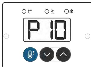
Рисунок 4 — Значение коэффициента пропорциональности на табло
